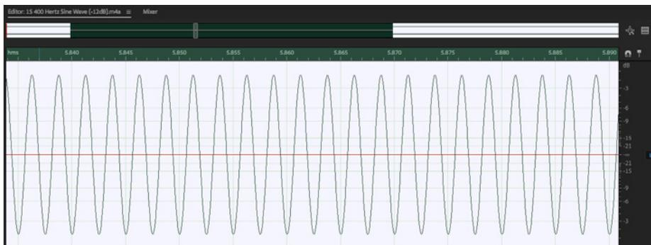
**Si reproduce una onda sinusoidal pura en un altavoz a alta potencia, la bobina de voz se calentará muy rápidamente porque la potencia media es alta. Una onda cuadrada reproducida a la máxima potencia del amplificador entregará el doble de potencia a lo largo del tiempo que la onda sinusoidal, calentando la bobina del altavoz incluso más rápidamente que la onda sinusoidal.**
